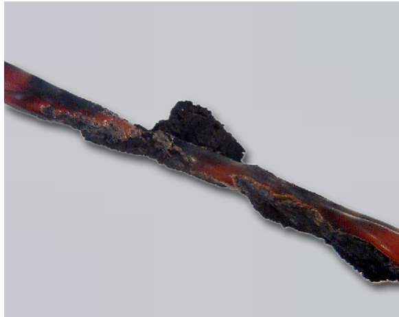
Linear Detection Wire Melting Point 356° f
